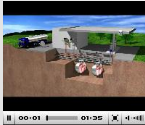
Mehrere unterirdische doppelwandige Behälter mit einem Überdruck-Leckanzeiger und Verteilerleiste
